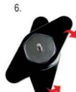
Mit dem Opening Tool das Feingwinde rechtsherum ca. 1/4 Umdrehung schließen.
