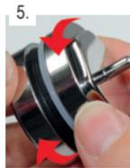
Logger aufeinander setzen und Feingwinde erst nach links drehen bis das Gewinde rechts herum leicht zu schließen ist. Handfest andrehen.
