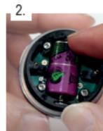
Batterie am Pluspol leicht Richtung Feder drücken und entnehmen.
