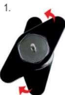
Mit dem Opening Tool das Feingewinde linksherum am Logger öffnen.
