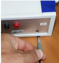
Verbinden Sie das separate Netzteil mit dem Messgerät(siehe Bild von Geräte-Rückseite) und stecken Sie den Netzstecker in einer Steckdose 230V/50Hz. Vor dem Einschalten den/die Messfühler in die dafür vorgesehene Buchse des Messinstrumentes anstecken. Die Fühleranschlussbuchsen sind entsprechend am Gerätegehäuse(Frontseite) mit 1 oder 2 gekennzeichnet.
