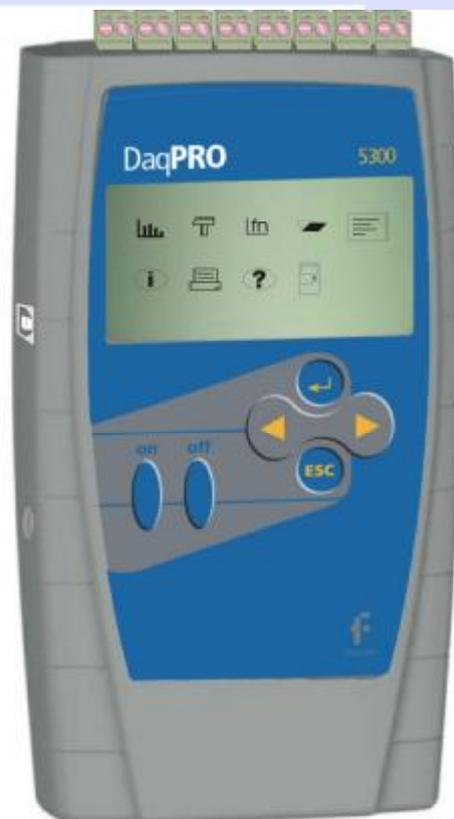
1. **Sensoreingänge/Alarmausgang** – abnehmbare Klemmenblocks mit Schraubklemmen (von rechts bis links mit Eingang 1 bis Eingang 8 beschriftet). Alle acht Eingänge können gleichzeitig verwendet werden. Wenn Sie nur einen Sensor verwenden, schließen Sie diesen an Eingang 1 an. Wenn Sie zwei Sensoren
